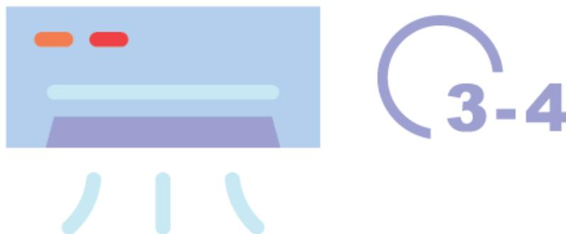
**02 Desligue a unidade e corte a alimentação do equipamento, desligando o disjuntor ou retirando a ficha de alimentação da tomada.**
